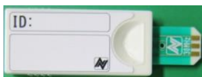
図6 QCM センサ (ケース組立後)
