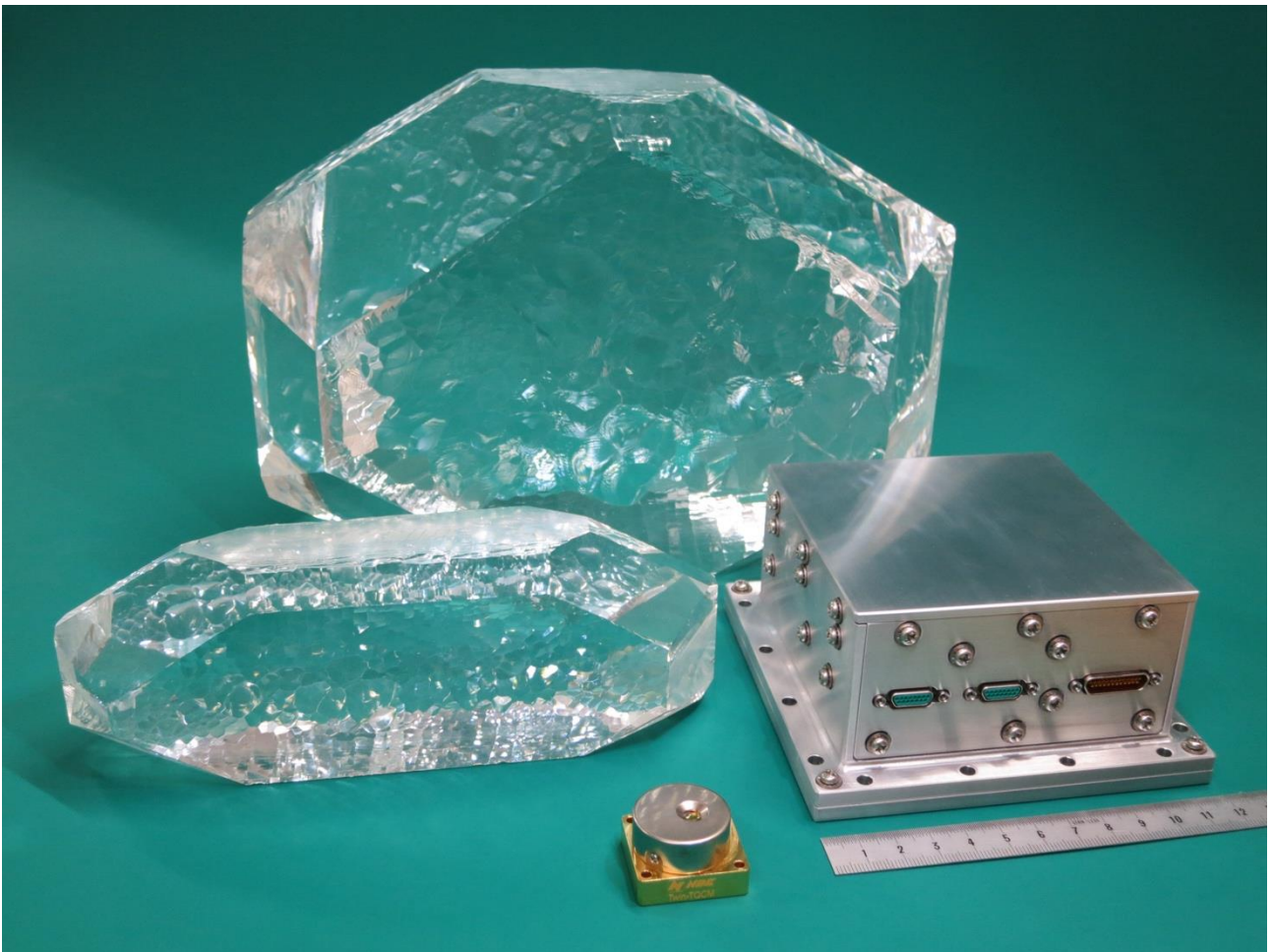
フライト用 Twin-QCM システム センサモジュール EM(手前)、コントローラ EM(右)
