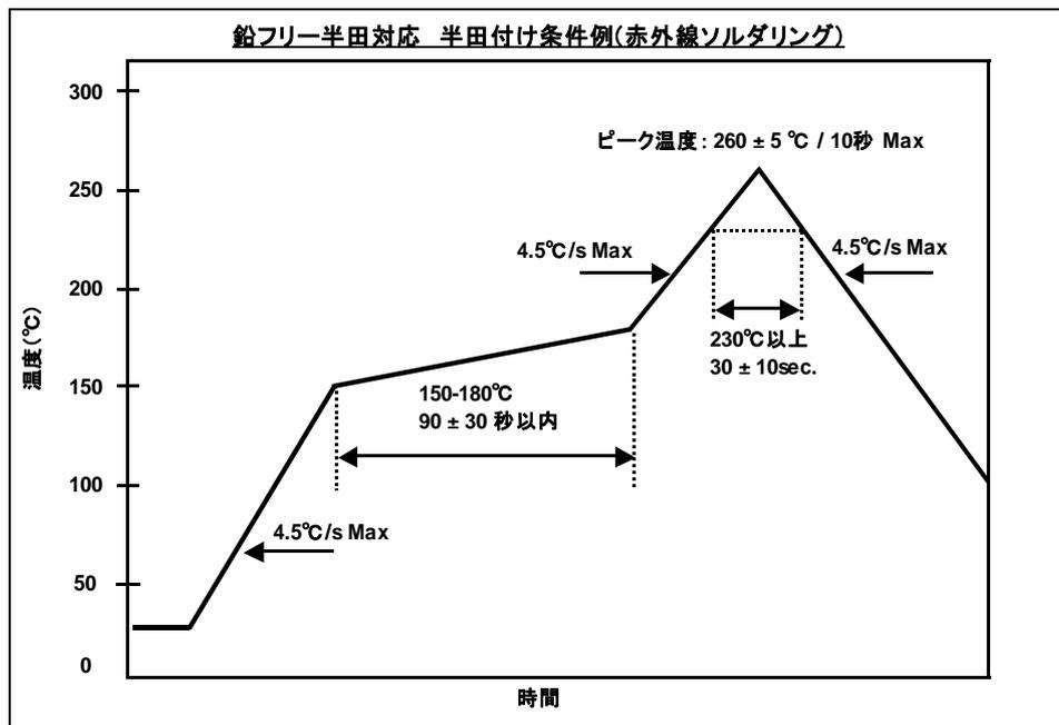
特性の劣化または、破壊を招く恐れがありますので下記を超える条件でのご使用を禁止させていただきます。
